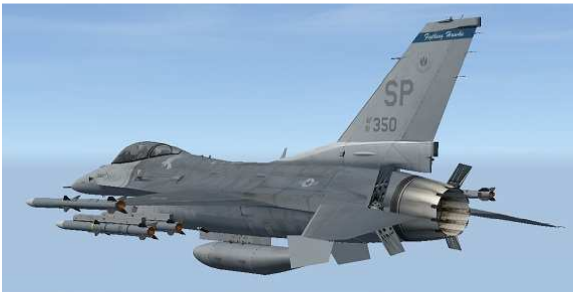
Les aérofreins complètement déployés, à l'arrière de l'appareil.
