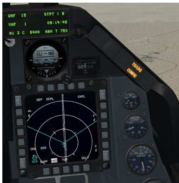
Le voyant TO/LDG CONFIG allumé sur la casquette droite.
